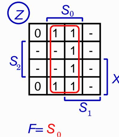
Considere a barragem representada na figura em que S<sub>2</sub>, S<sub>1</sub> e S<sub>0</sub> são sensores que detectam a presença de água nos respectivos níveis, gerando um “1” lógico.
